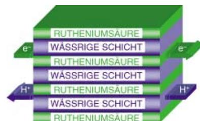
Voraussetzungen für die Anwendung in elektrochemischen Superkondensatoren.
